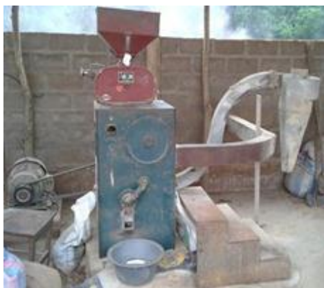
Figure 18 : Décortiqueuse à rouleau
